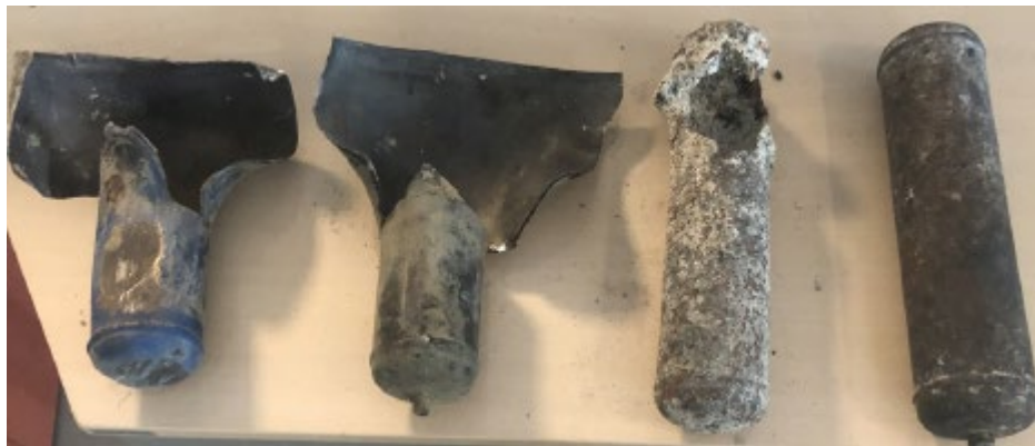
Des cartouches format « bouteille » dont certaines ont éclaté après passage dans l'incinérateur.
